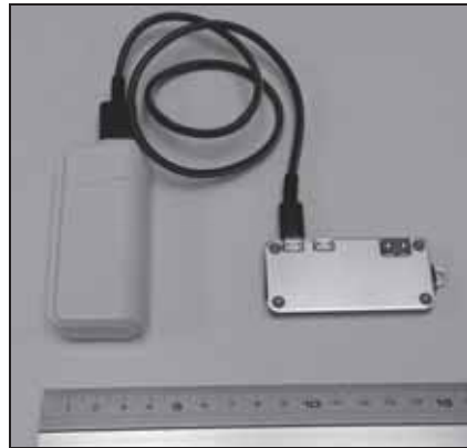
図7 システム運用筐体及び電源外観
